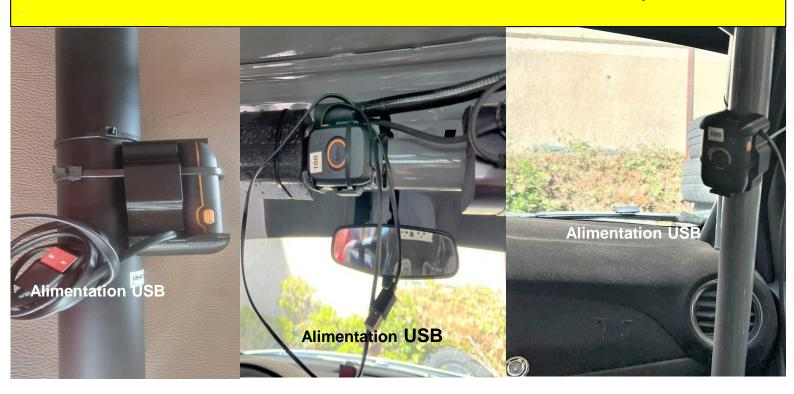
Le boîtier se met en marche à la mise en charge ou avec un appui long de 5 secondes sur le bouton Marche/Arrêt situé sur le côté droit du boîtier (fig 1) le boitier vibre et les leds clignotent : il est OK. Il se mettra en pause automatiquement après un arrêt de 5 minutes et redémarrera automatiquement sitôt la voiture en mouvement.
